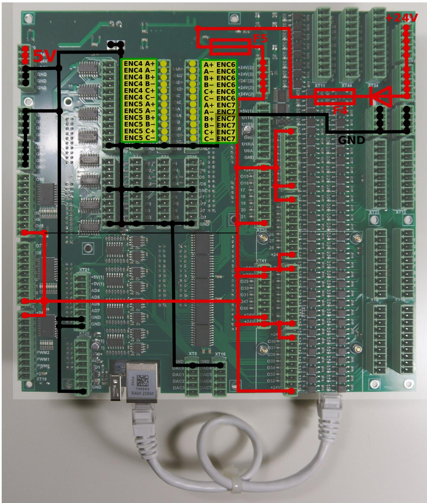
Входы энкодера отображаются в списке входов общего назначения, зарезервированы адреса от 64 до 87. Плата ET15 может использовать до 88 двоичных входов.
