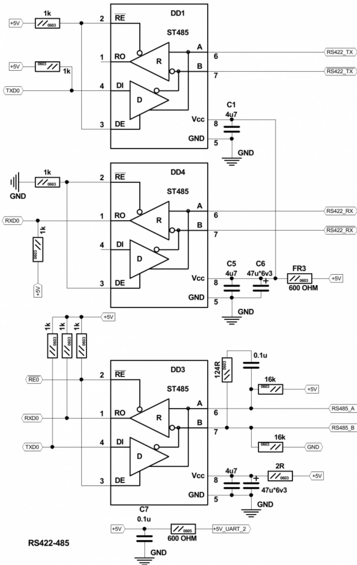
Плата управления myCNC-ET15 имеет разъем для шины RS422/RS485. Схема контактов разъема
