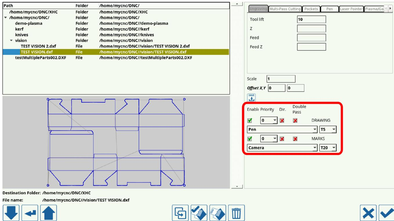
4. После загрузки файла DXF программа должна вставить макросы M397, M398 и M399, которые относятся к системе CNC Vision, в G-code программы.
