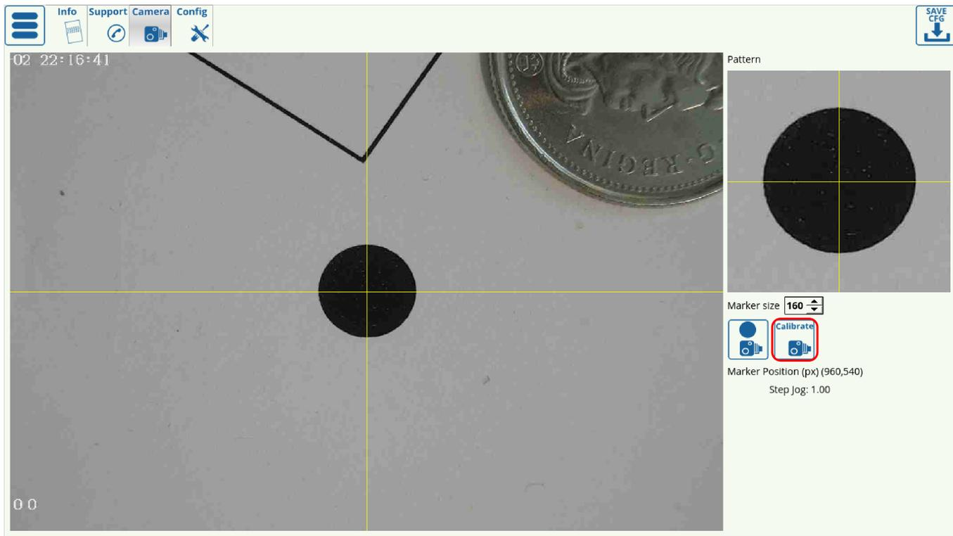
Процесс калибровки должен быть завершен после перемещения камеры в положительном и отрицательном направлениях по обеим осям, и результаты должны быть отмечены в меню Settings > Config > Camera:
