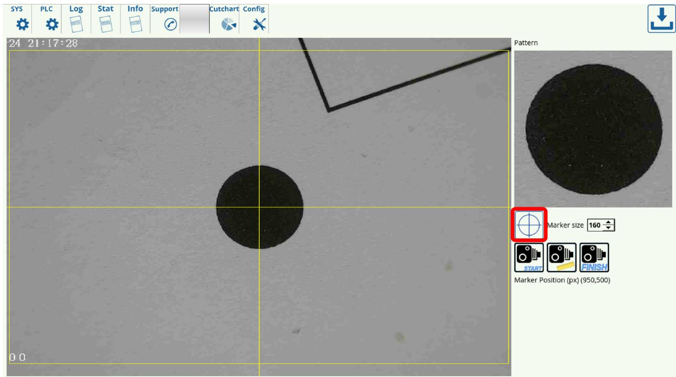
3. Нажмите кнопки **Start** и **Measure** и запомните положение камеры по осям X и Y камеры перед ее перемещением.
