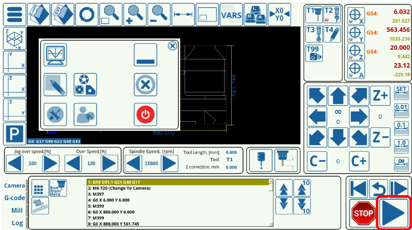
Машина будет перемещать камеру в направлении предполагаемых положений маркера, и, если маркеры не будут там найдены, будет перемещаться вокруг этого предполагаемого положения маркера на расстоянии, заданное значением Camera Shift. После выполнения макросов камеры и определения местоположения всех маркеров, программа автоматически отрегулирует смещение или искажение рабочего материала и немедленно начнет запуск основной программы.
