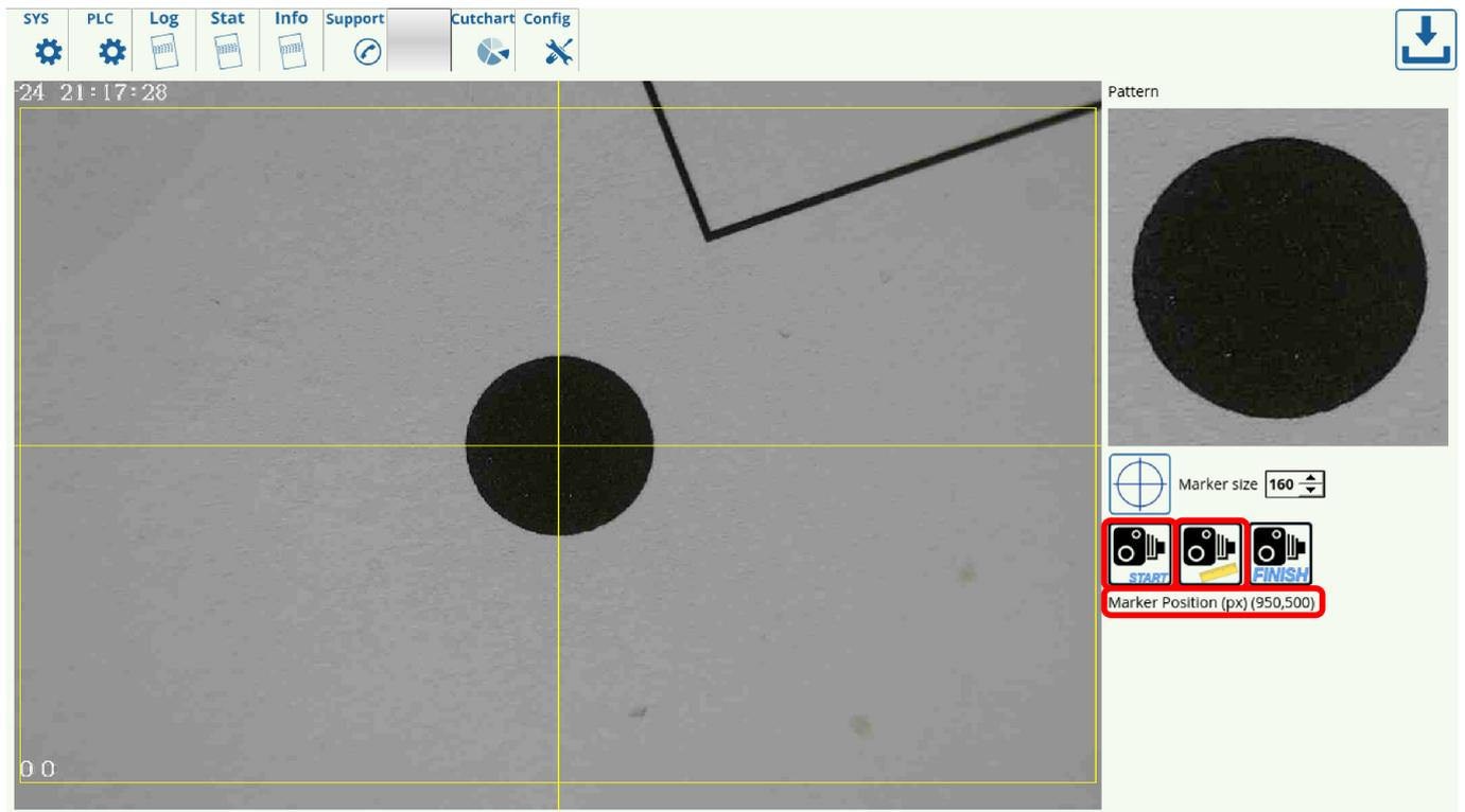
4. Переместите камеру на некоторое расстояние (в мм) и запишите это расстояние. Обратите внимание на изменение исходного положения XY в пикселях и подсчитайте, сколько пикселей камера прошла за этот переезд. Разделите миллиметры на пиксели, чтобы получить коэффициент для каждой соответствующей оси.
